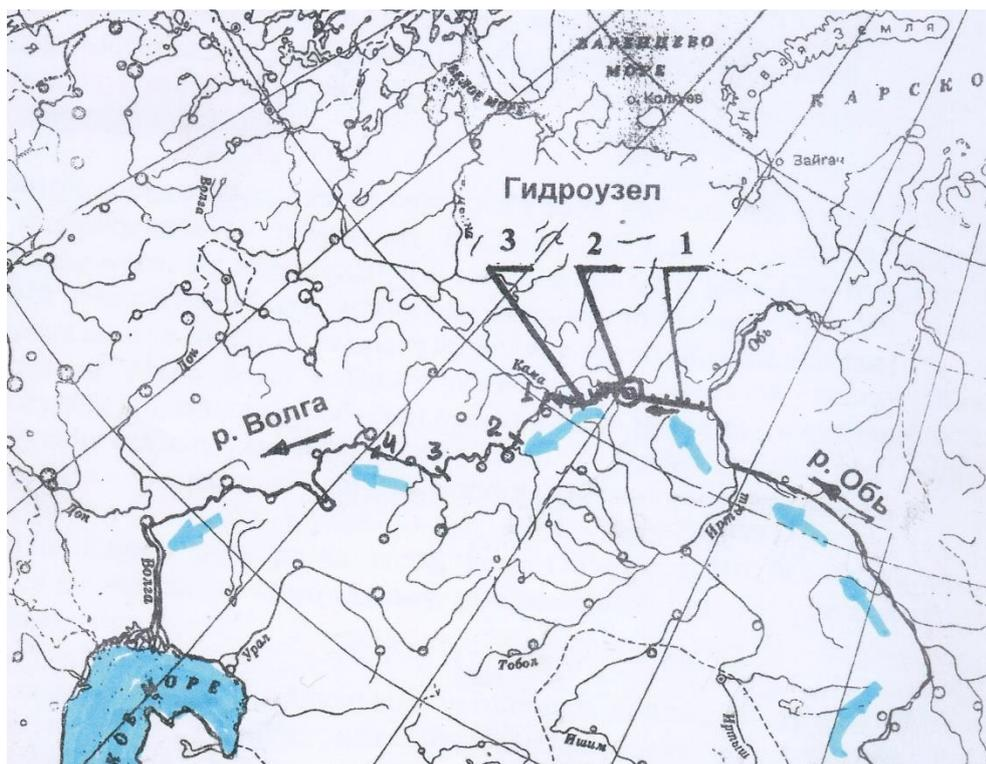
Рисунок 1 Схема переброски воды из р. Обь в р. Волга
