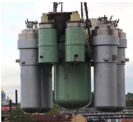
Рисунок 2. Блочная реакторная установка КЛТ-40С
