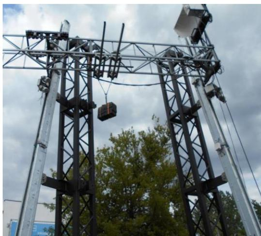
Рисунок 1. Испытания 23-метровой платформы подъемника на стенде
