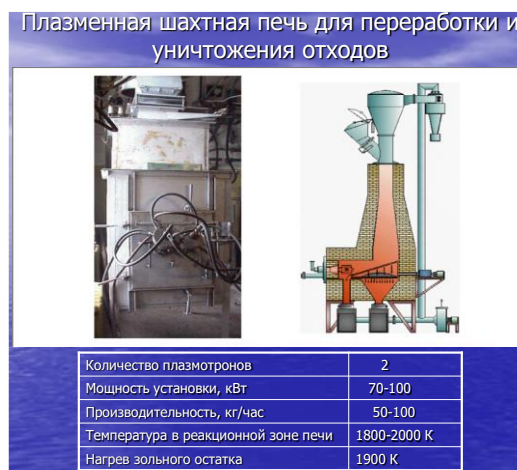
Рисунок 4 Высокотемпературная плазмотермическая установка ООО «Плазмактор»
