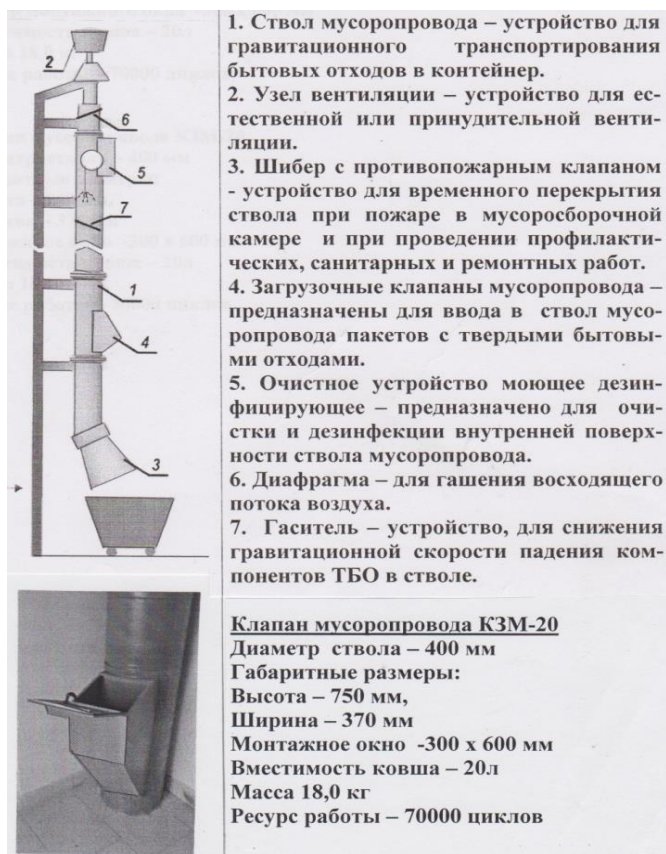
Рисунок 1 Схема мусоропровода М-400-20 для многоэтажных жилых зданий.
