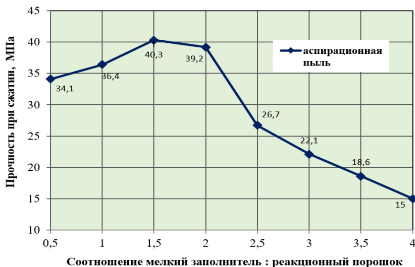
Рисунок 1. Зависимость соотношения М.З./РК на прочность композита
