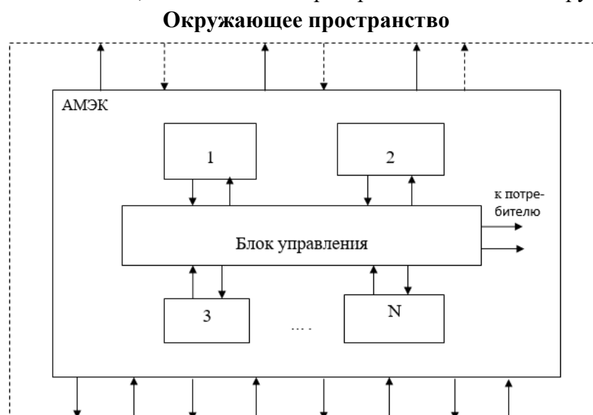
Рисунок 1 Блок-схема автономного многофункционального энергетического комплекса (АМЭК) на ВИЭ; 1,2,3... № - преобразователи естественных энергетических потоков различных типов
