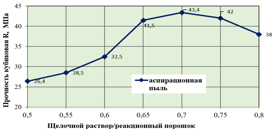
Рисунок 2. Зависимость влияния отношения ЩР/РК на прочность
