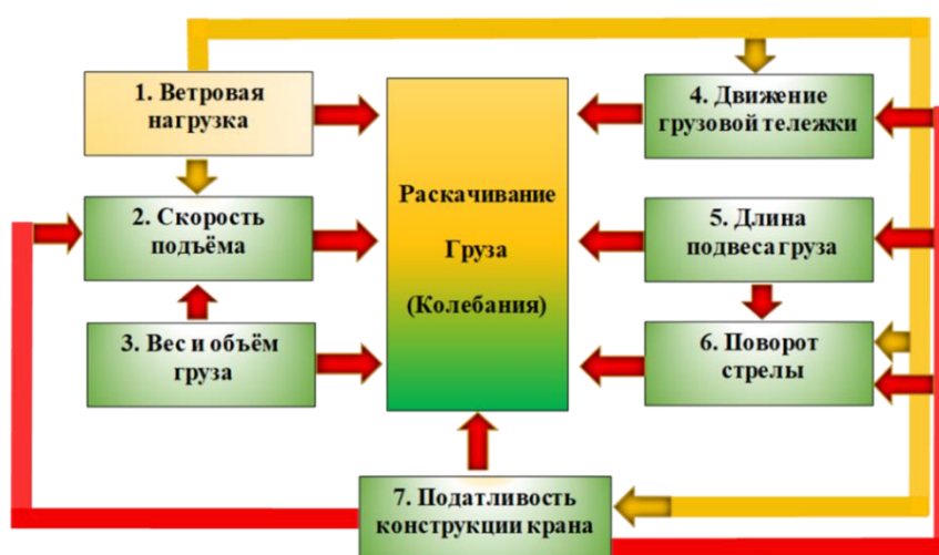
Рисунок 1. Взаимодействие основных факторов, влияющих на раскачивание груза.
