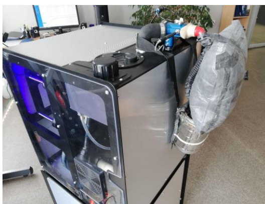
Рисунок 4. Испытание самоспасателя на имитаторе внешнего дыхания «ОКСИ-РОБОТ» при моделировании движения человека по маршруту шахты.
