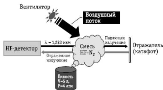
Рис. 1. Схема эксперимента по дистанционной диагностике HF в открытой атмосфере
